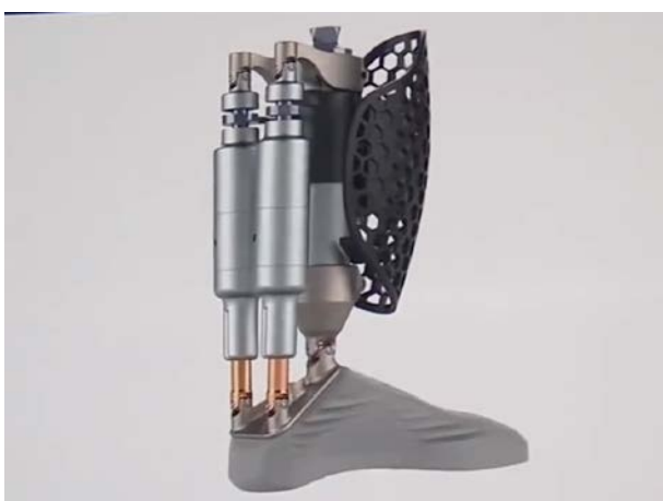
図1 3軸構造のバイオニクス義足
